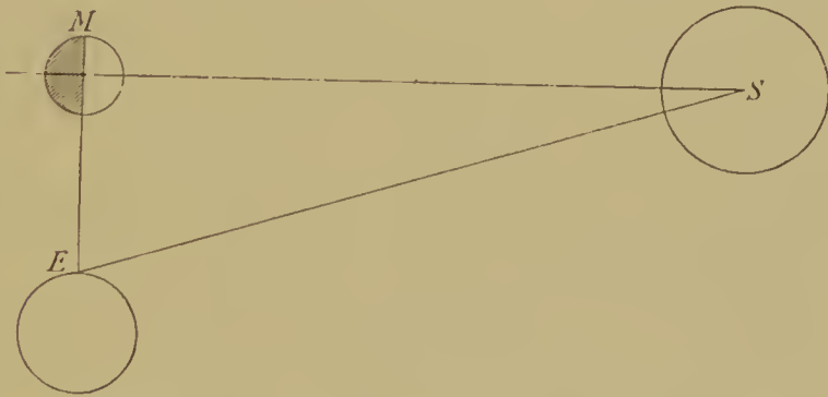
Abb. 18. Aristarchs Verfahren, die Entfernung des Mondes und der Sonne zu bestimmen.
